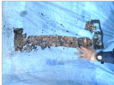
荷箱から発見された焼けただれた蓄電池
