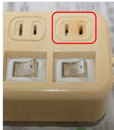
耐用年数(※)を超えた状態で、**たこ足配線**をして使用し続けていたもの。自己点検により、差込部防熱により溶け、変色しているのを発見したもの。このままの状態で使用し続けていた場合、**接触不良等で出火する危険**があった。
