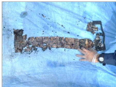
荷箱から発見された焼けたリチウムイオン電池
