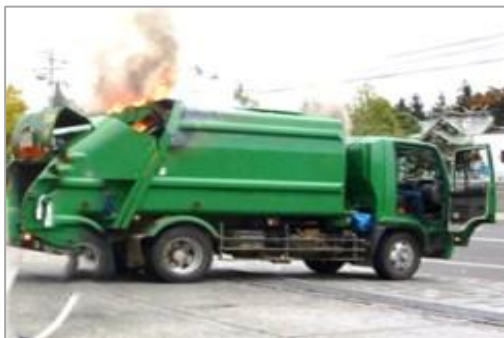
荷箱内でリチウムイオン電池が押し潰されて出火
